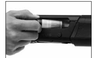
Stoppa in en patron genom utkastarluckan i lådan.
