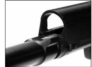
Выровняйте толкатель с пазом ствольной коробки
