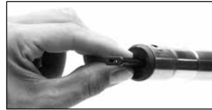
Demontering av treskottsadapter.
