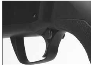
Предохранитель в боевом положении.
