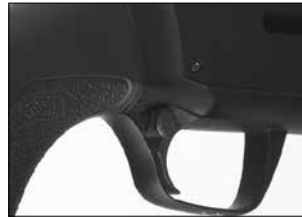
Предохранитель в безопасном положении.
