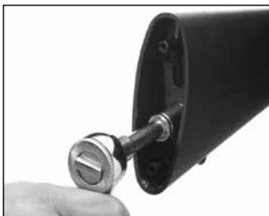
Usare una chiave a tubo per estrarre le viti di fissaggio del calcio.
