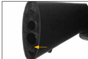
Снимите вкладыш приклада
