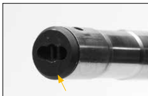
Изображение ограничителя на три выстрела, закрепленного на трубчатом магазине
